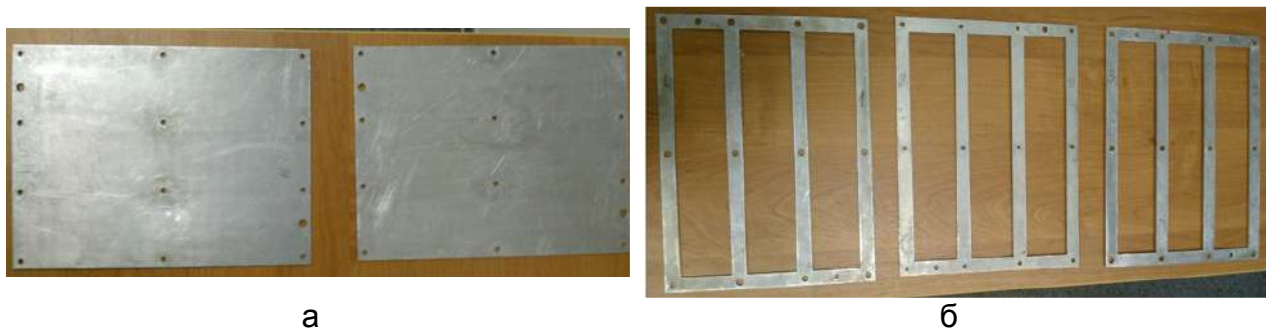
Рис 1. Форма для изготовления пластины из композиционных материалов: а – основание и крышка; б – вставки
