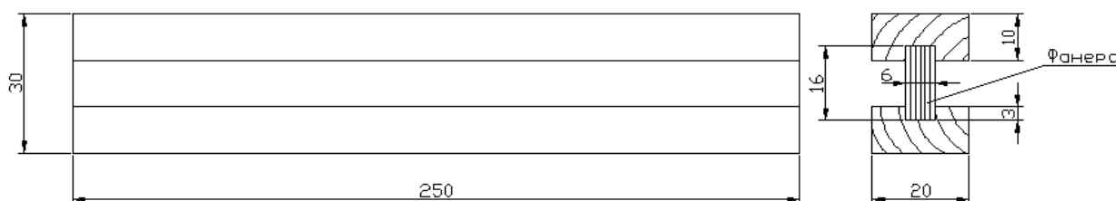
Рис. 3. Образец для испытаний «Балка комбинированная»
